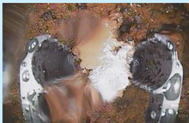
2号機での堆積物接触調査
